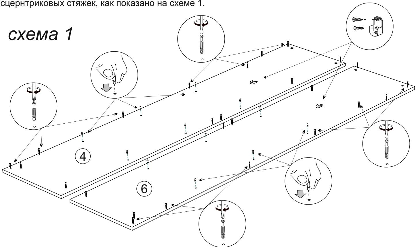
3. Соберите корпус шкафа. Для этого соберите между собой боковины №4 и №6, вязки №8 и планки №7 и №10 при помощи эксцентриковых стяжек, как показано на схеме 2.
