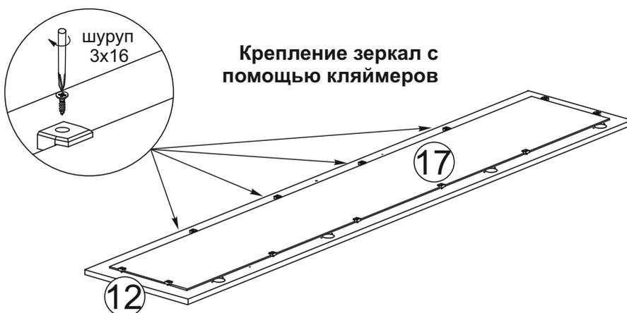
Крепление зеркал с помощью кляймеров
