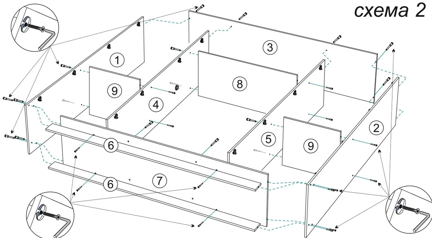
4. Чтобы установить задние стенки (детали №13, №14), необходимо собранную конструкцию перевернуть лицевой стороной вниз. Замерить, с помощью рулетки, и уровнять диагонали ( $a=b$ ). Наложить задние стенки предварительно соединив №13 брусом для ЛДВП №16 и аккуратно, не нарушая диагоналей, прибить ЛДВП гвоздями, с шагом 130-150 мм, затем также гвоздями прибить подпятники на боковины и цоколя, (схема 3).
