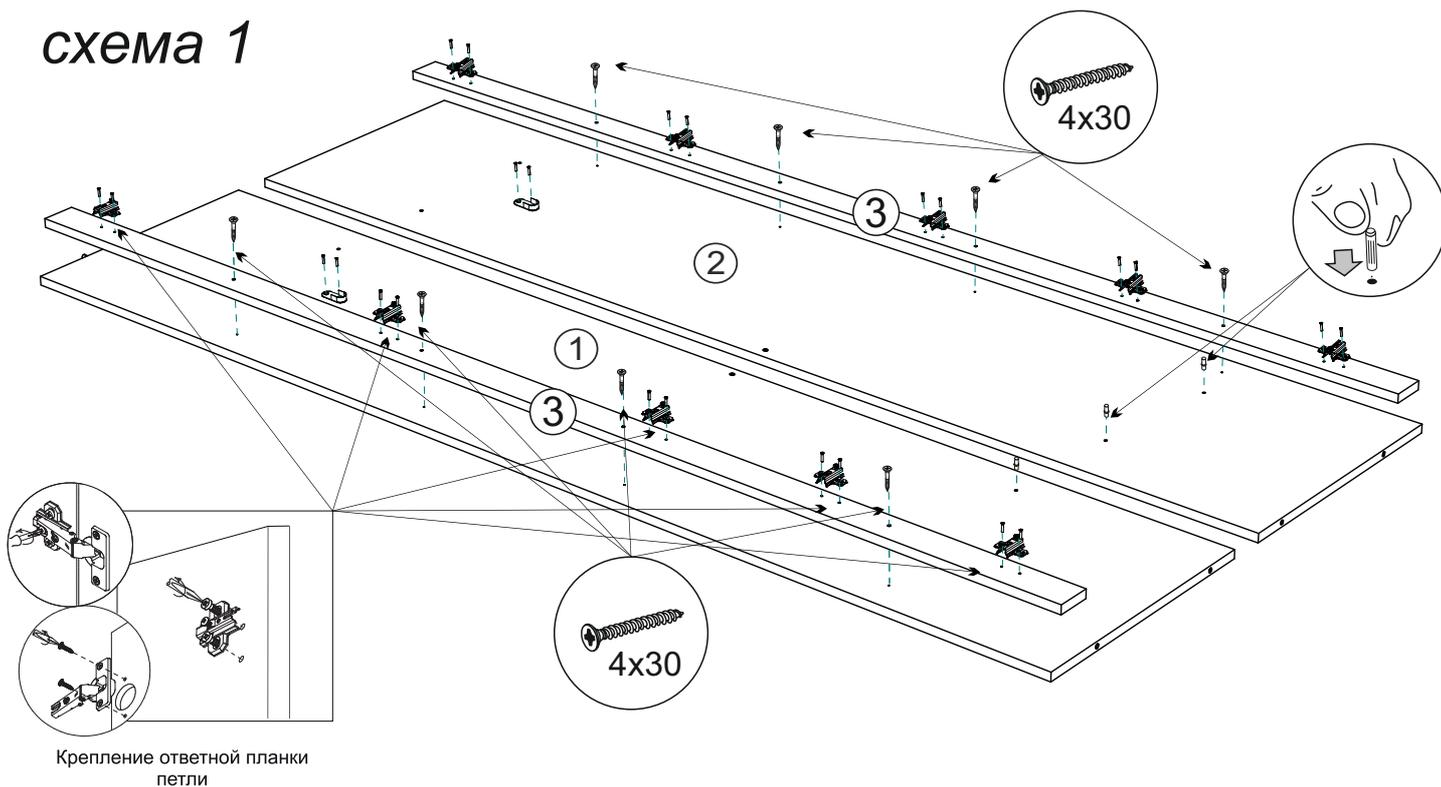
3. Соберите каркас шкафа. Для этого соедините боковины №1 и №2 евровинтами вязкой №5, затем ими же прикрепите крышки №4 а планки №7 прикрутите шурупами 4x30 по наметкам к крышкам. Установите опоры на шурупах 4x25, как показано на схеме 2.
